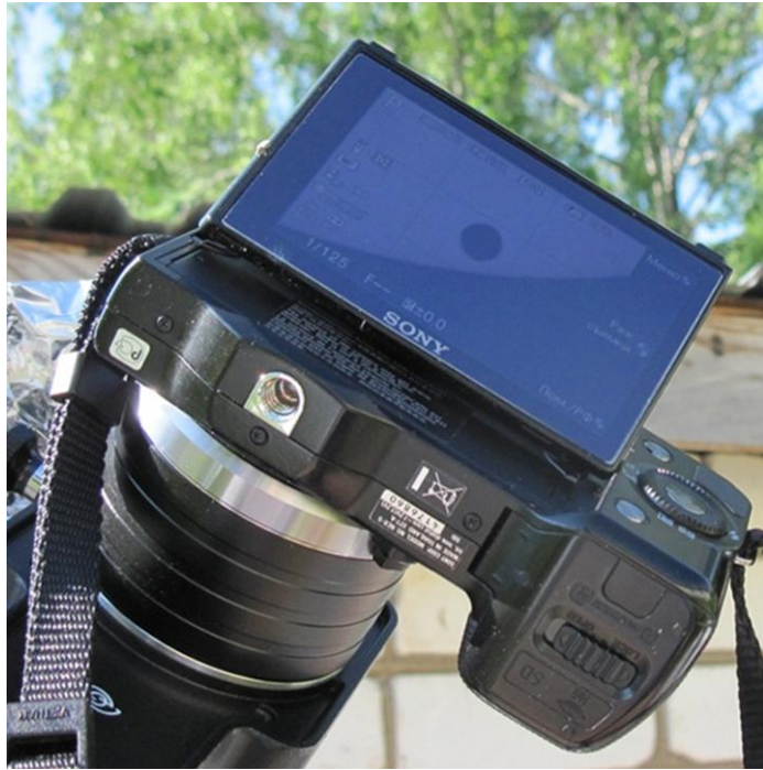
Рис. 6. Фотоаппарат Sony NEX-5, сопряженный с телескопом Celestron C8-NGT
